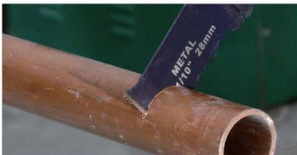
**双金属材料锯片双断齿形锯铜管**
